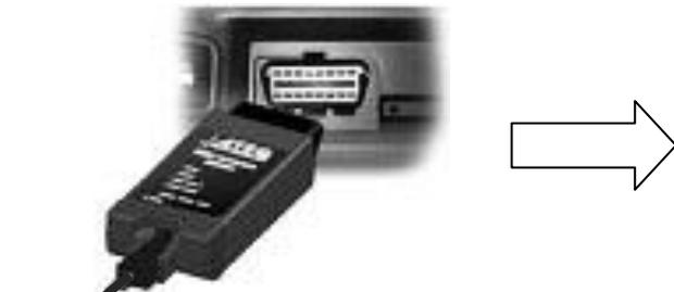
Figure 1 Collegare OBD sullo Strumento ATEQ VT56
