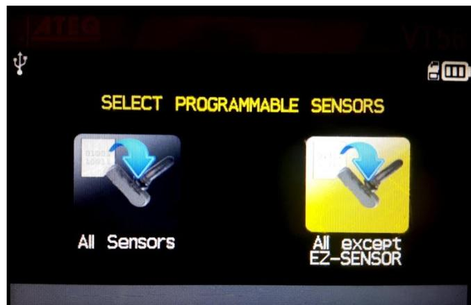
**Selezionare l'icona di destra dove è scritto ALL EXCEPT EZ-SENSOR.** Sarà ora possibile Clonare e programmare i sensori Orange Electronic. Quest'operazione di reset può esser effettuata tutte le volte in cui si necessita fare lo switch.
